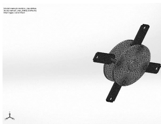
Fig. 4.22. Discretizarea în elemente finite tetraedrale a modelului
